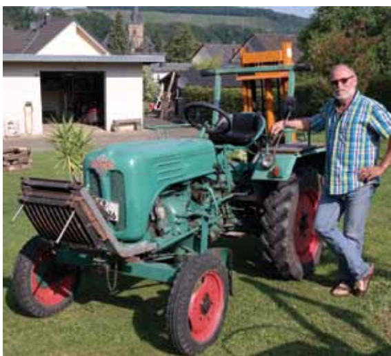
Kramer KL 150 Bauzeit v. 1961-1967 / 1365 Stück, 1 Zylinder luftgekühlt, 850 cm 3 10,2 KW / 14 PS, 6 Gänge, Geschwindigkeit 20 km/h, Gewicht 1150 kg
