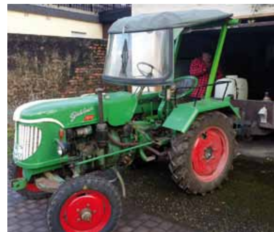
Güldner ADN 15 Bauzeit v. 1953 – 1958, 2 Zylinder, wassergekühlt, 1300 cm 3 15 PS 5/1 Gänge, Geschwindigkeit 19 km/h, Gewicht 1100 kg
