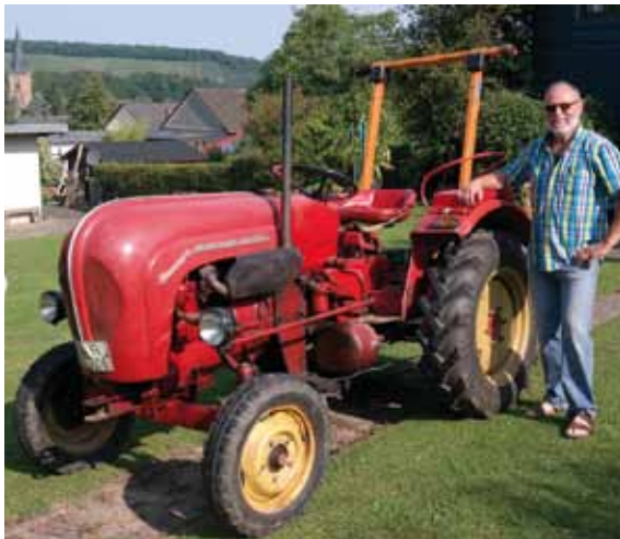
Porsche Standard T 217 Bauzeit 1960 – 1962 / 6800 Stk, 2 Zylinder luftgekühlt, 1374 cm 3 14,6 KW / 20 PS, 8/2 Gänge, Geschwindigkeit 20 km/h, Gewicht 1125 kg
